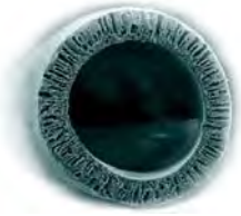
Sezione fibra cava Hollow fiber section
